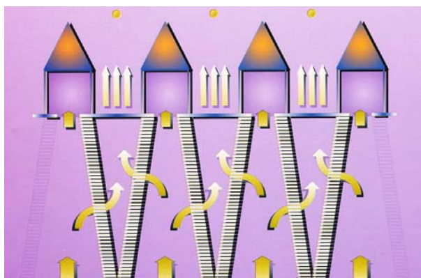
Рис. 11. Схема работы КВОУ AAF AS. Проход воздуха через фильтры.
