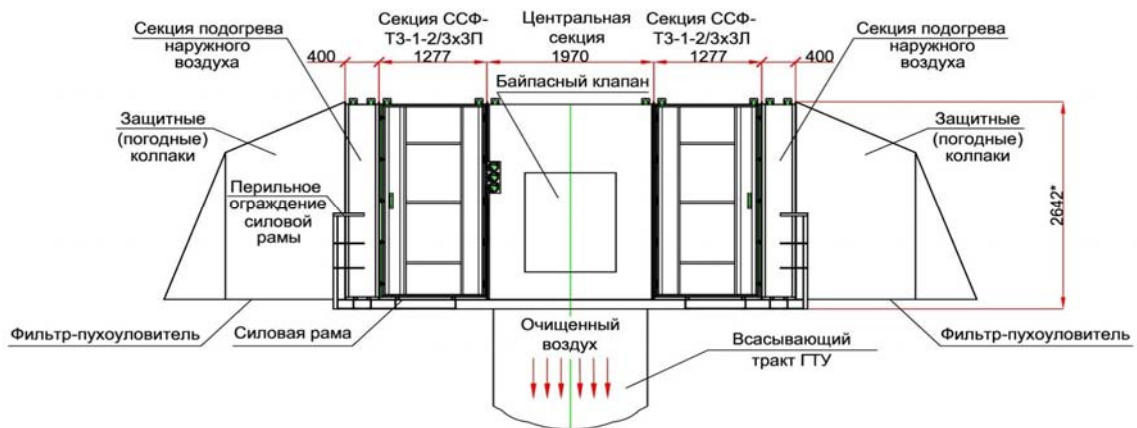
Принципиальная схема одного из вариантов ВОУ (КВОУ) для ГПА-Ц-6,3.
