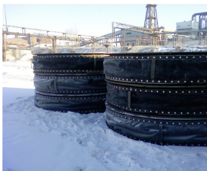
Компенсаторы газоходов до ЭФ
