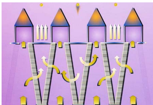
Рис. 12. Схема работы КВОУ AAF AS. Импульсная очистка фильтрующей панели.
