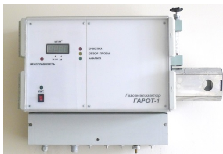
Рис. 4. Многодетекторный газоанализатор с системой разбавления
