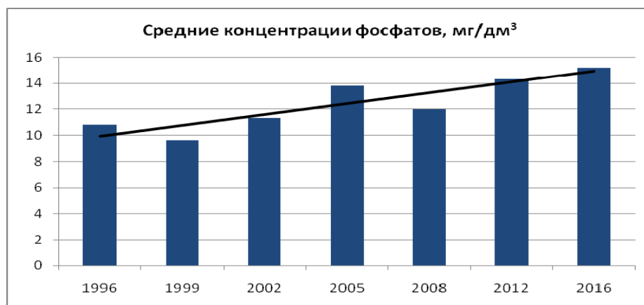
Рисунок. Изменение концентраций фосфатов в сточных водах на входе очистных сооружений.
