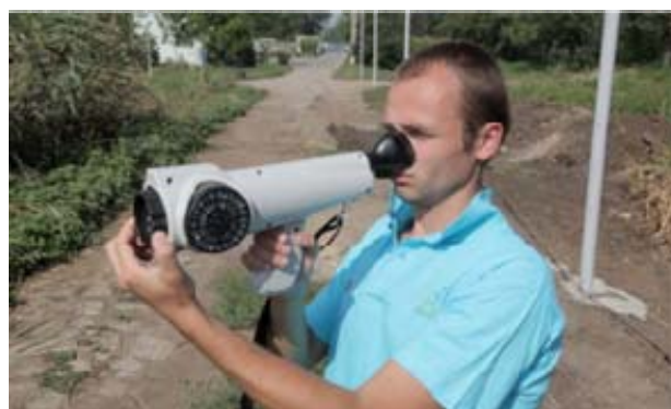
Рисунок 2. Оценка интенсивности запаха полевым ольфактометром
